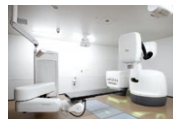
サイバーナイフ 精密工業で使われている高精度ロボットアームに小型の放射線発生装置を搭載
